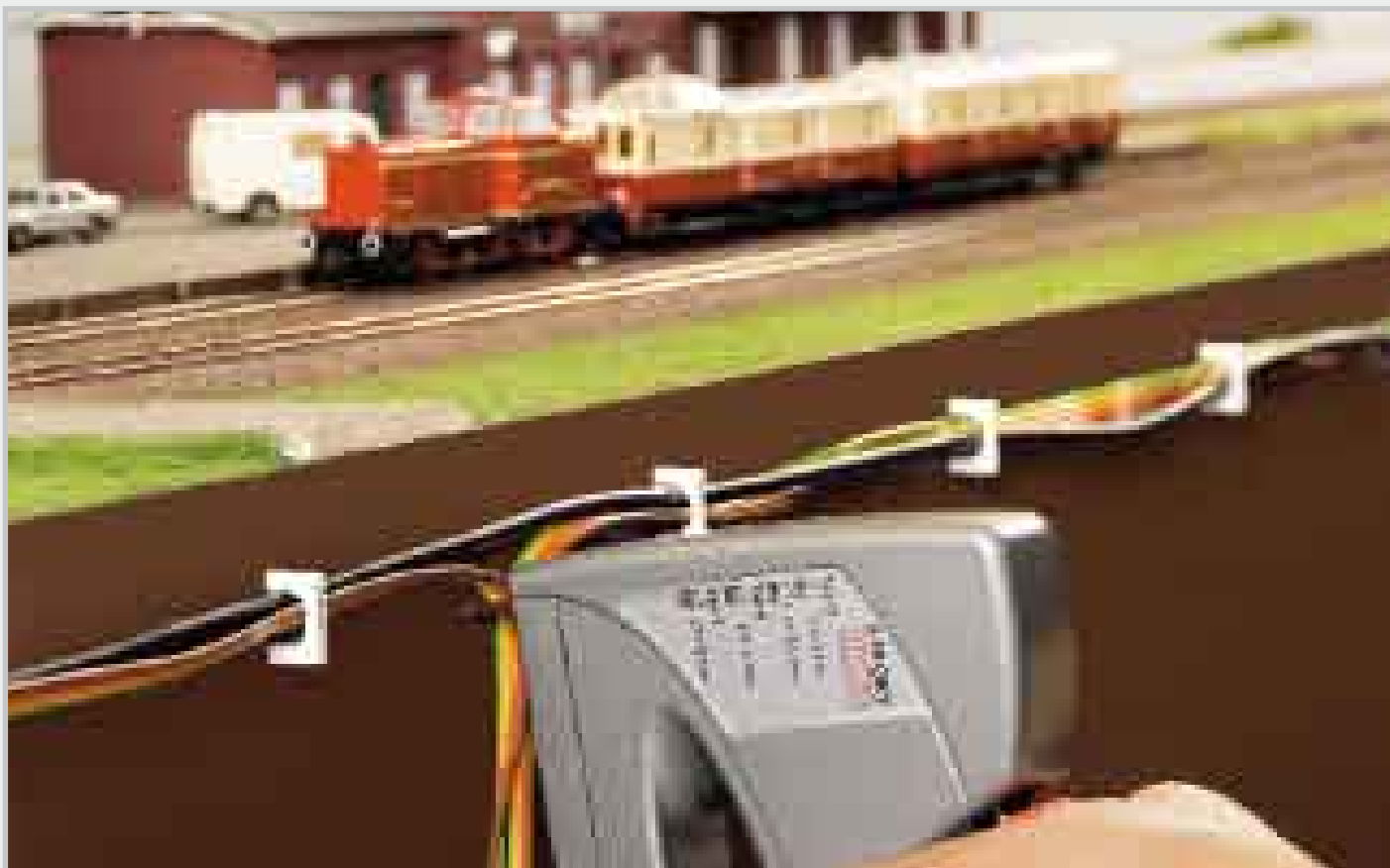
Различните кабели могат да се полагат чисто с помощта на такера за кабели.
