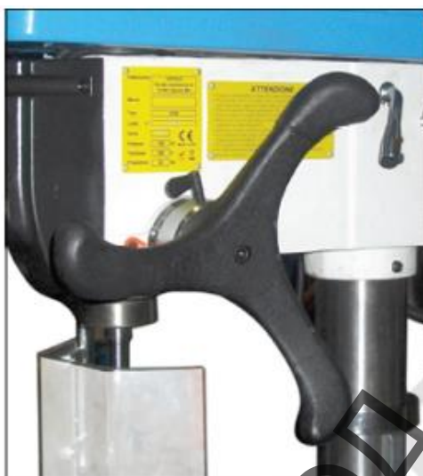
Фигура 11 – Задействане на шпиндела
