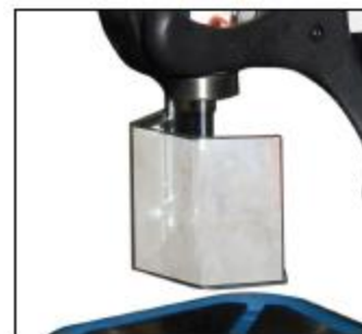
Фигура 14 – Предпазител на шпиндела
