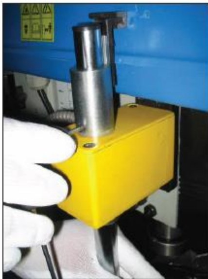
Фигура 2 – Инсталиране на носещия прът на предпазителя.
