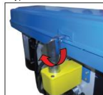
Фигура 13 – Заклучен кожух на макарите
