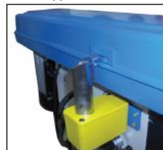
Фигура 15 – Заключване на кожуха на ролката
