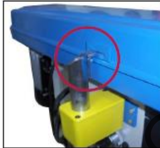
Фигура 18 – Блокировка на кожуха на шайбите
