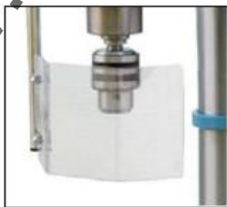
Фигура 17 – Подвижен екран на патронника с блокировка
