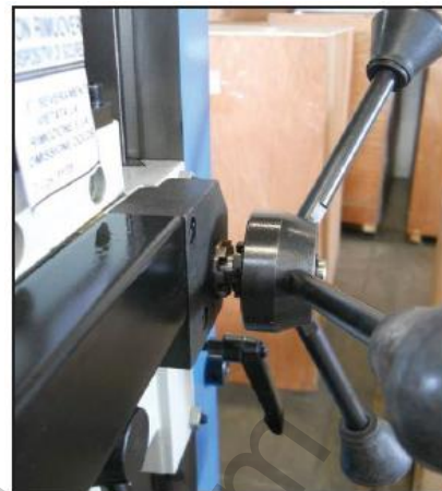
Фигура 11 – Лост за фиксиране на ръчно управляемото колело
