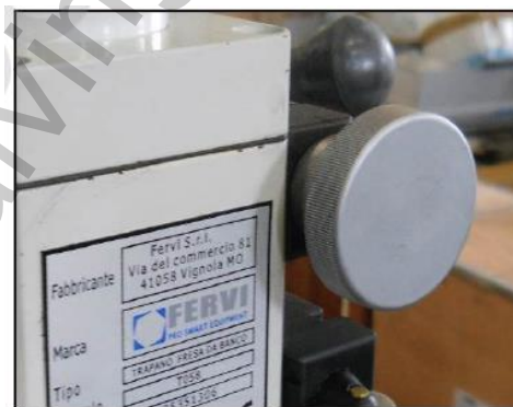
Фигура 6 – Винт за калибрирано преместване
