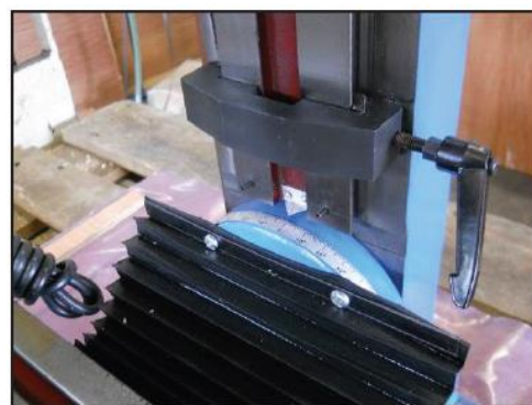
Фигура 10 – Лост за регулиране на фиксатора на главата
