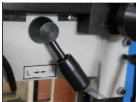
Фигура 21 – Лост за настройка на скоростта
