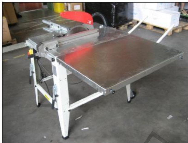
Фигура 24 – Монтиране на удължителя на плота.
