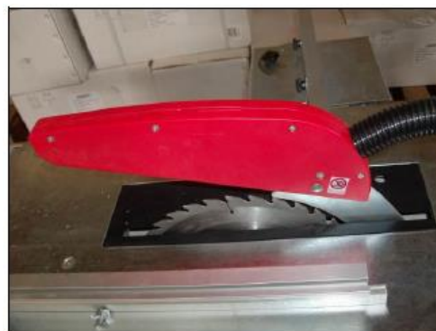
Фигура 5 – Предпазител на режещия диск.
