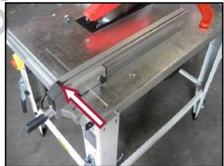
Фигура 23 – Монтиране на скобата за определяне на дължината на рязане.
