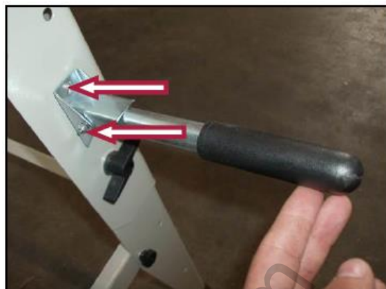
Фигура 15 – Фиксиране на ръкохватките.
