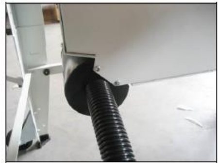
Фигура 21 – Свързване на тръбата на прахоуловителя.
