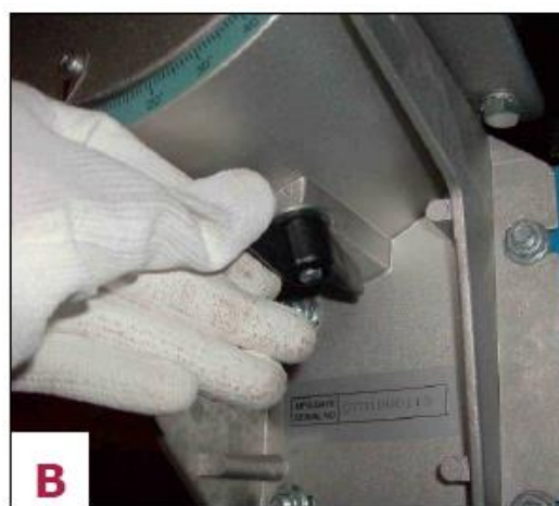
Фигура 12 – Бутон за наклоняване на работния плот и настройка.
