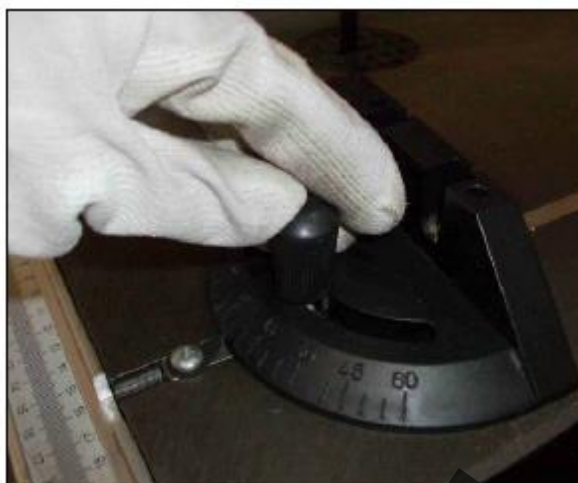
Фигура 20 – Регулиране на ъгломерния механизъм.
