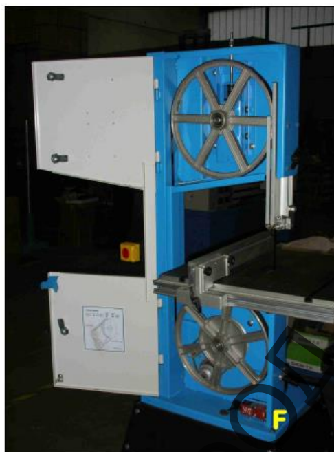
Фигура 13 – Подвижен предпазител на отделението на ролките с блокиращ микропрекъсвач (позиция F).
