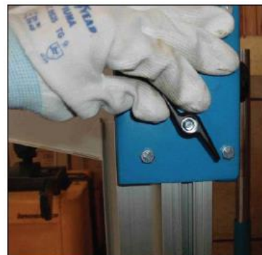
Фигура 9 – Настройка на предпазителя на лентата.
