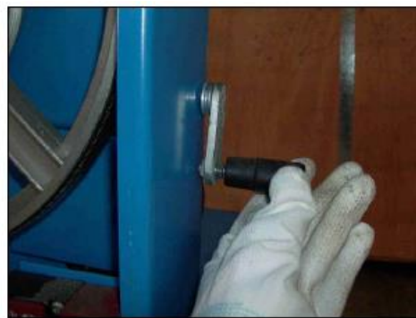
Фигура 25 – Разхлабване на задвижващия ремък.
