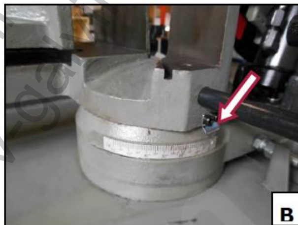
Фигура 26 – Настройка на позицията на главата
