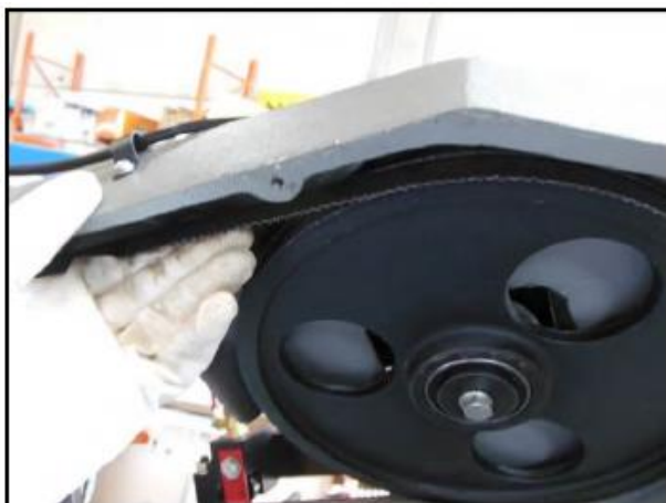
Фигура 39 – Монтаж и опъване на лентата
