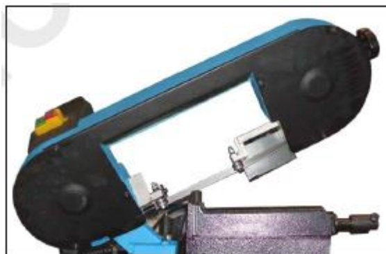
Фигура 35 – Отваряне на предпазния кожух
