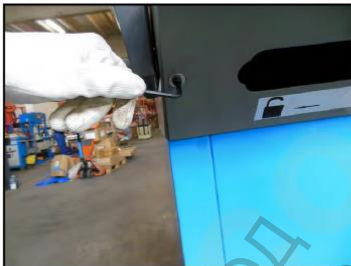
Фигура 20 – Демонтаж на предния панел
