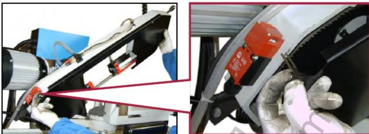
Фигура 36 – Демонтаж на предпазния капак на лентата
