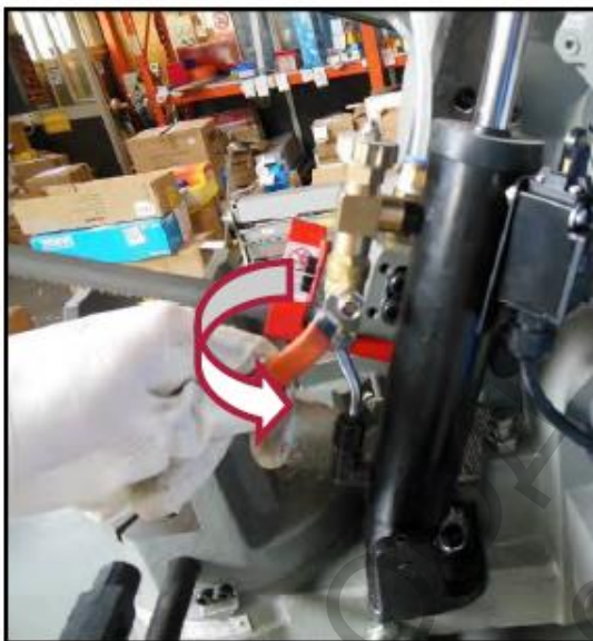
Фигура 31 – Отваряне на клапана
