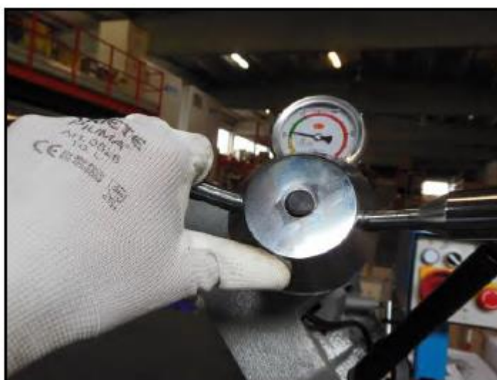
Фигура 38 – Намаляване на натягането на лентата
