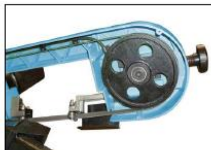
Фигура 18 – Затваряне на лентата
