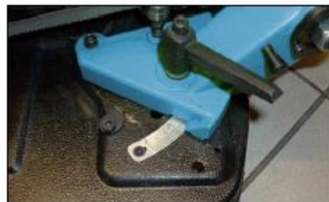
Фигура 13 – Настройка на позицията на главата
