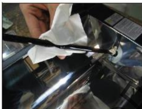
Фигура 7 – Демонтаж на лампата.
