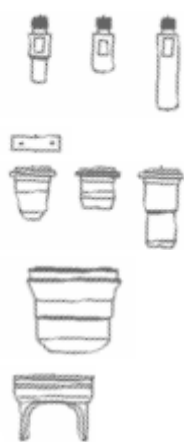
Фигура 5: Оформление на главата на горелката
