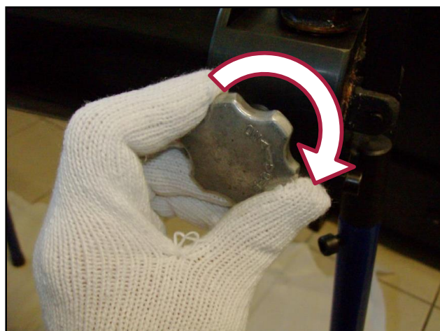
Фигура 24 - Затваряне на клапана за освобождаване на хидравличния цилиндър.
