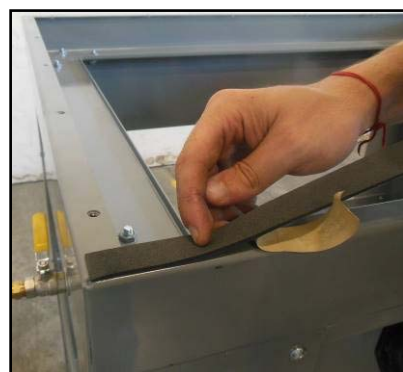
Фигура10 - Монтаж на изолация върху скобата.
