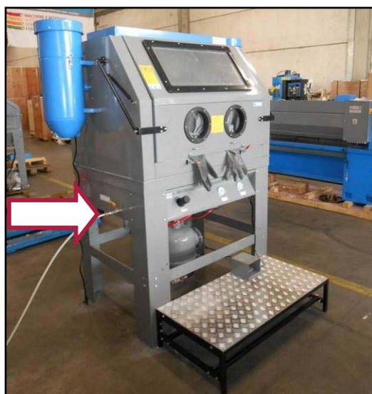
Фигура19 – Присъединяване на сгъстен въздух.
