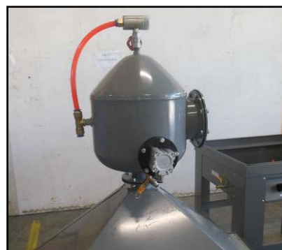
Фигура11 - свързване на резервоара за абразив към бункера.
