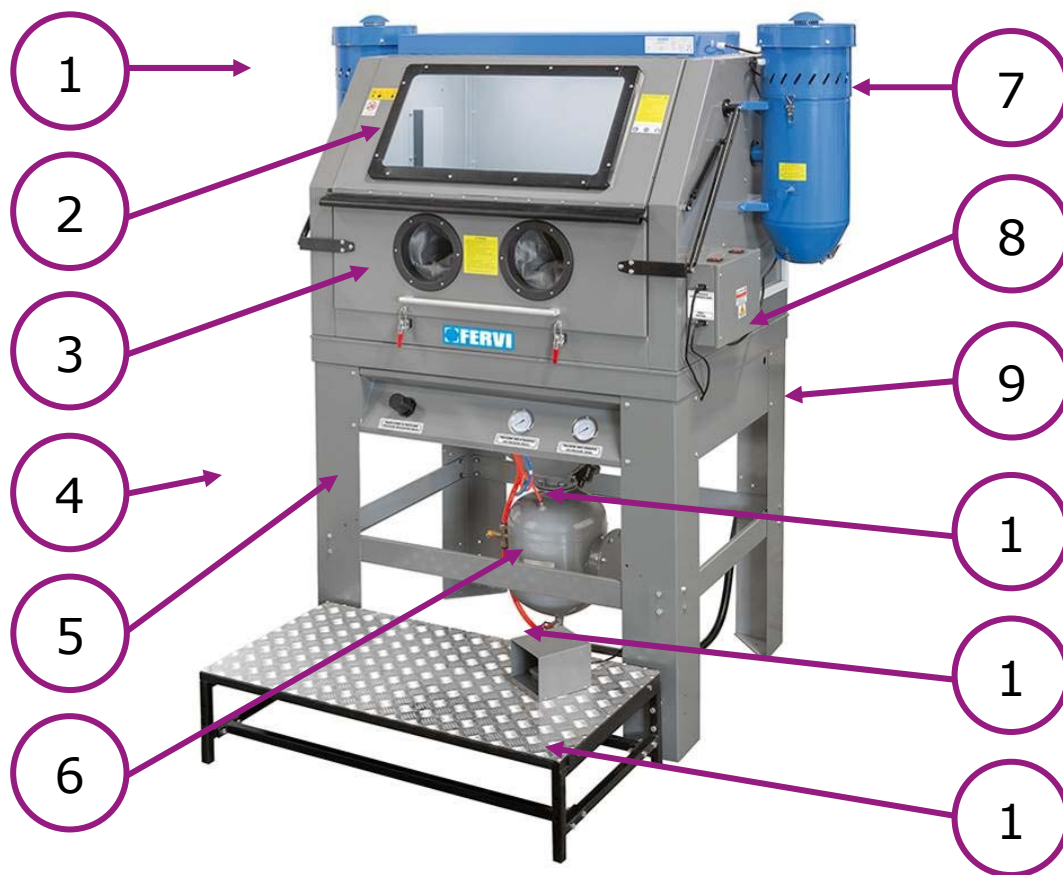
Фигура1 – Основни части на пясъкоструйната машина.
