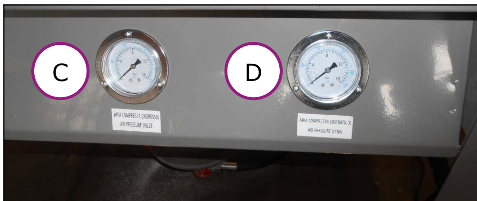
Фигура22 - манометри за контрол на налягането на сгъстения въздух.
