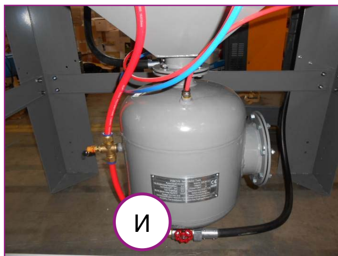
Фигура23 - Регулиращ клапан за потока на абразивния материал.
