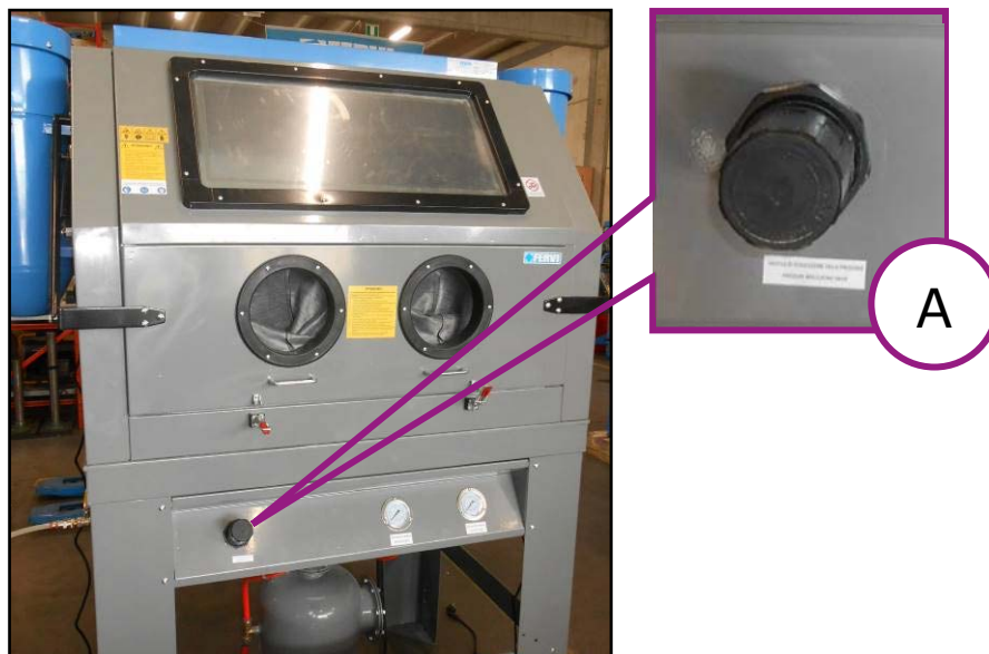
Фигура20 – Напорен клапан и манометър.
