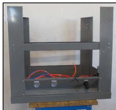
Фигура9 - Монтаж на планките за управление и крана за съгстен въздух.
