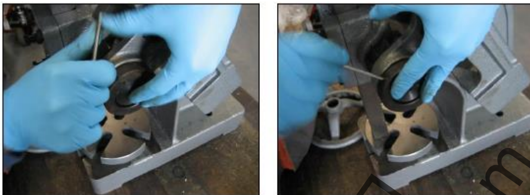
Фигура 7 – Монтаж на блокиращия пръстен
