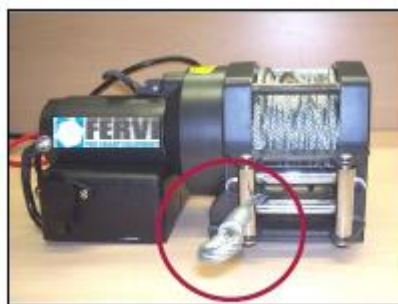
Фигура 6 – Водач на въжето / монтаж на водача
