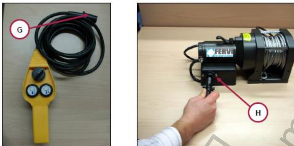
Фигура 11 – Свързване на устройството за управление към лебедката
