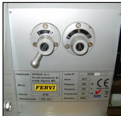
Фигура 4 – Панел за промяна на скоростта на шпиндела.
