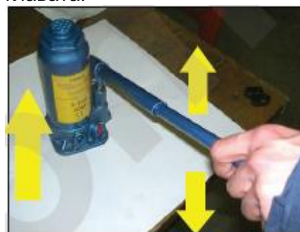
Фигура 9 – Помпене за повдигане.
