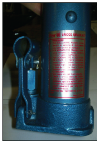
Фигура 5 – Близък план на пиктограмите, поставени на задната страна на крика.
