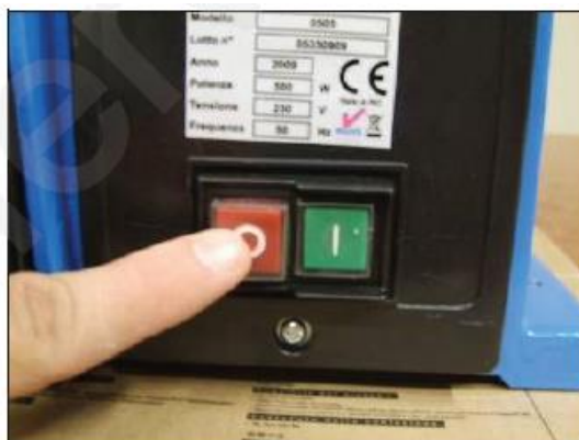
Фигура 15 – Спиране на шлифовъчната машина.
