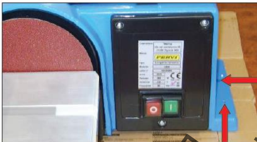
Фигура 10 – Отвори за закрепване в близък план.
