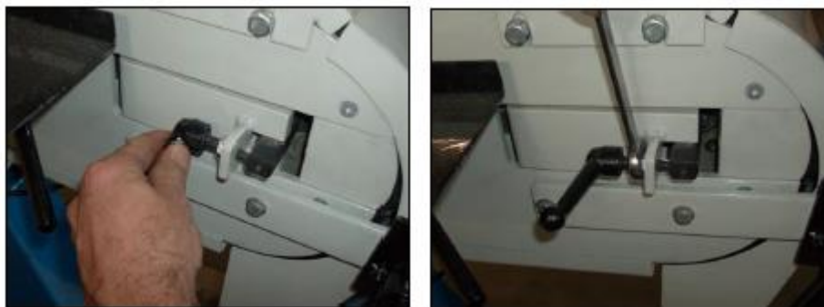
Фигура 6 – Лост за освобождаване на натягането на лентата.
