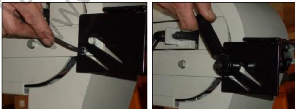
Фигура 15 – Монтаж на опора – предна част
