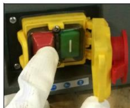
Фигура 15 – Спиране на шлифовъчния диск.
