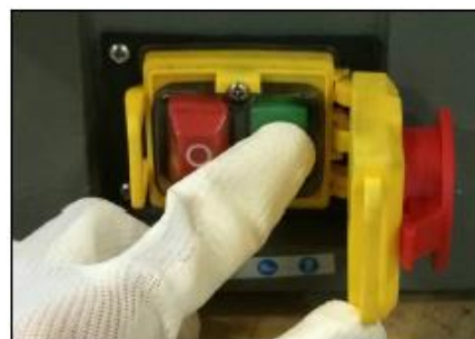
Фигура 14 – Стартиране на шлифовъчния диск.
