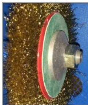
Фигура 18 – Фиксираща гайка и фланец
