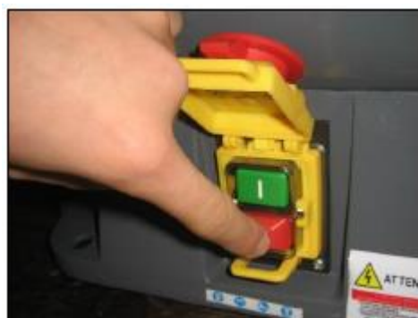
Фигура 15 – Спиране на шлифовъчния диск.
