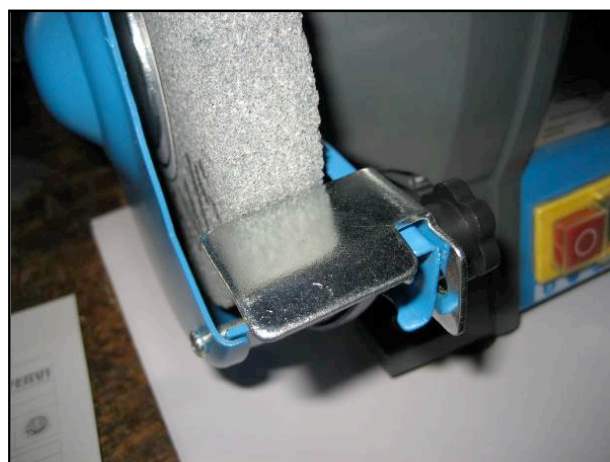
Фигура 6 – разполагане на защитни екрани при шмиргеловия камък
