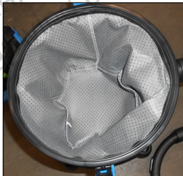
Фигура 8 – монтаж на филтър глава-резервоар
