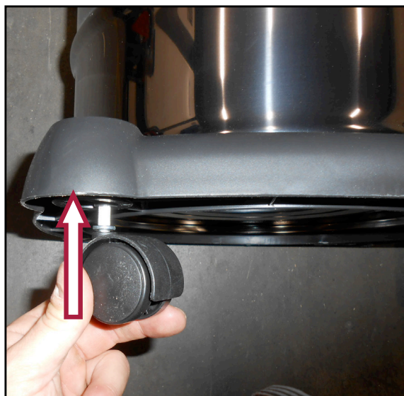
Фигура 6 – монтаж на предни въртящи се около оста си колела
