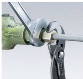
Клещи ключ като втори „ключ“ при законтрящи съединения
