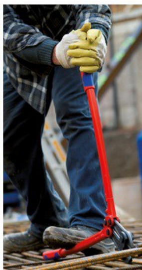
Кован ограничител за използване като демпфер: смекчава сътресението при рязане
