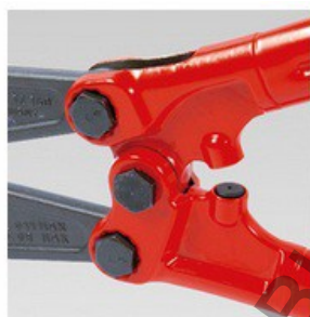
Кован ограничител за използване като демпфер: смекчава сътресението при рязане
