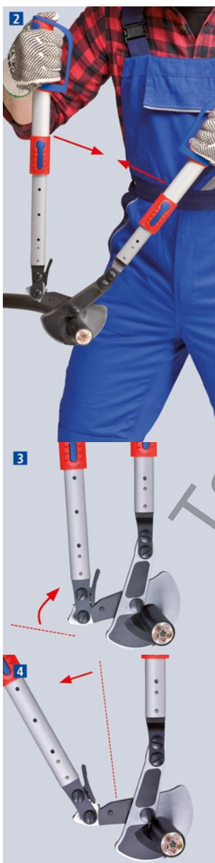
След първия частичен разрез отворете рамената посредством тресчотката
