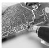
Спояване на елементи за повърхностен монтаж
